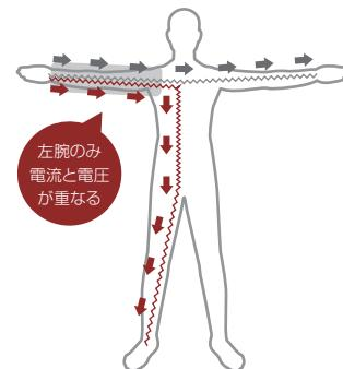
インピーダンスを使って体成分を求める方法をBIA法(生体電気インピーダンス分析法)と言い、安全で簡単な方法であることから、その基本原理は家庭用体組成計でも広く用いられています。主に医療・臨床研究で使用されるInBodyは測定の精度を上げるために、部位別測定の他にも多周波数分析・8点接触型電極などの技術を採用しています。
