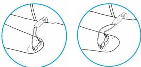
欠損部位の残存肢があまりに短いと測定ができないことがあります。そのような場合は、電極を横並びに貼り付けて残存肢の長さを確保してください。付着式電極は装着式電極に比べて、貼り付け位置の統一が難しくなります。正確にモニタリングしていただくために、付着式電極を使用する際は、毎回同じ場所に貼り付けるよう注意してください。
